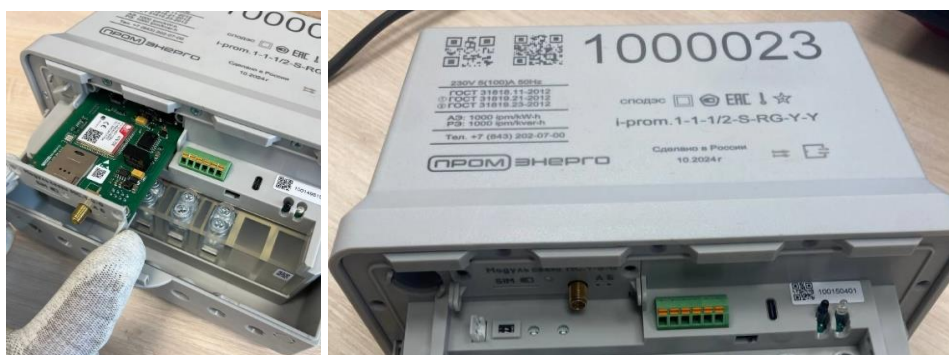
Рисунок 6 – Установка/снятие МС в счетчик электрической энергии однофазный многофункциональный i-prom.1 в корпусе «S»
