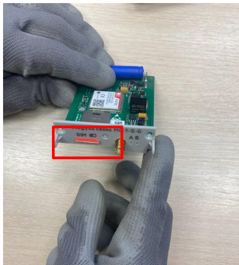
Рисунок 4 – Установка SIM карты в МС в счетчик электрической энергии однофазного многофункционального i-ргом.в корпусе «S»
