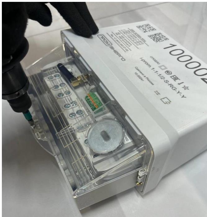
Рисунок 27 – Установка передней крышки счетчика электрической энергии однофазного многофункционального i-prom.1 в корпусе «S»
