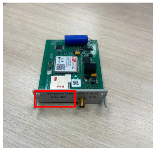
Рисунок 4 – Установка SIM карты в МС в счетчик электрической энергии однофазного многофункционального i-ргом.в корпусе «S»
