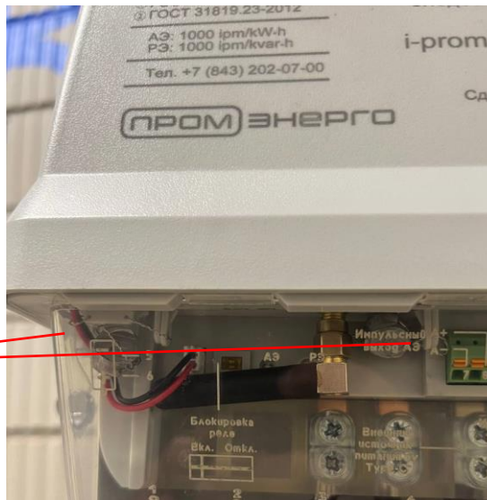
Рисунок 38 – Место установки пломб счетчик электрической энергии однофазный многофункциональный i-prom.1 в корпусе «S» - с дополнительным источником питания
