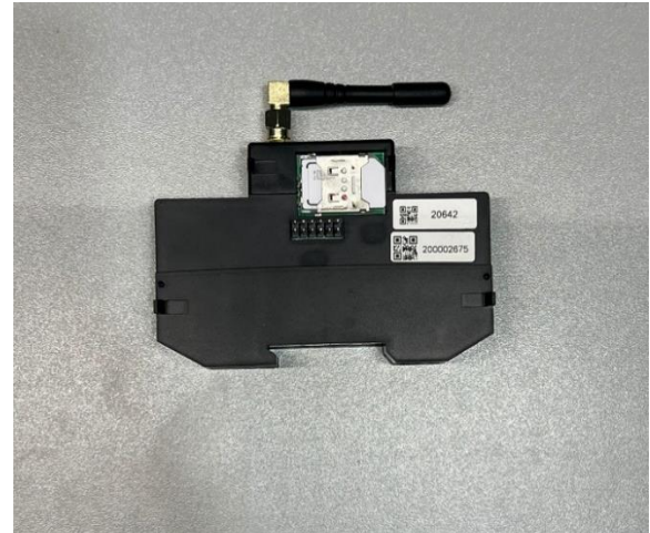
Рисунок 3 – Установка SIM карты в МС счетчика электрической энергии однофазного многофункционального i-ргом. в корпусе «М-МКД» без SIM карты
