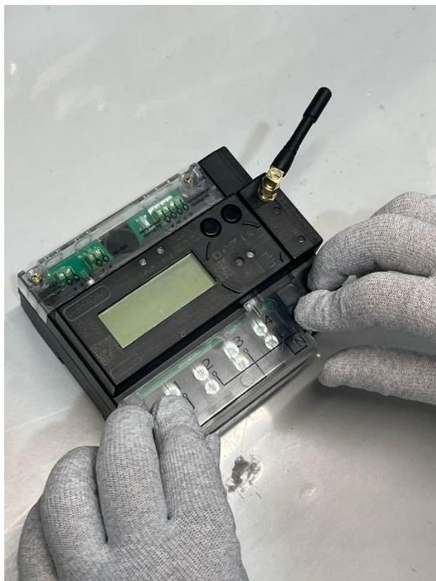
Рисунок 26 – Установка крышки клеммной колодки на счетчик электрической энергии однофазный многофункциональный i-rom.1 в корпусе «М-МКД»
