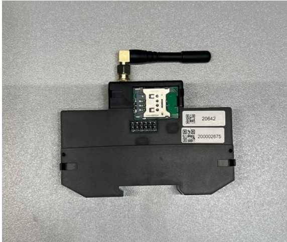
Рисунок 3 – Установка SIM карты в МС счетчика электрической энергии однофазного многофункционального i-ргом. в корпусе «М-МКД» без SIM карты
