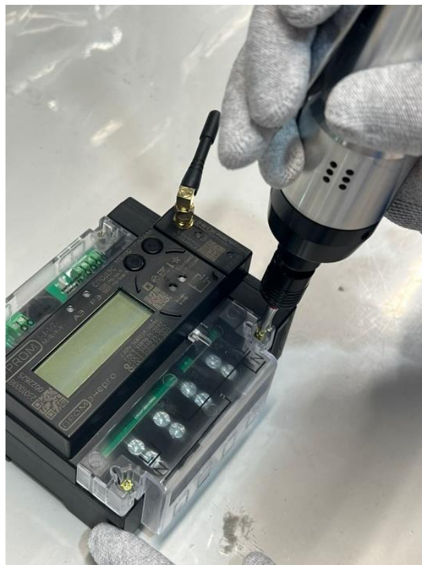
Рисунок 26 – Установка крышки клеммной колодки на счетчик электрической энергии однофазный многофункциональный i-rom.1 в корпусе «М-МКД»
