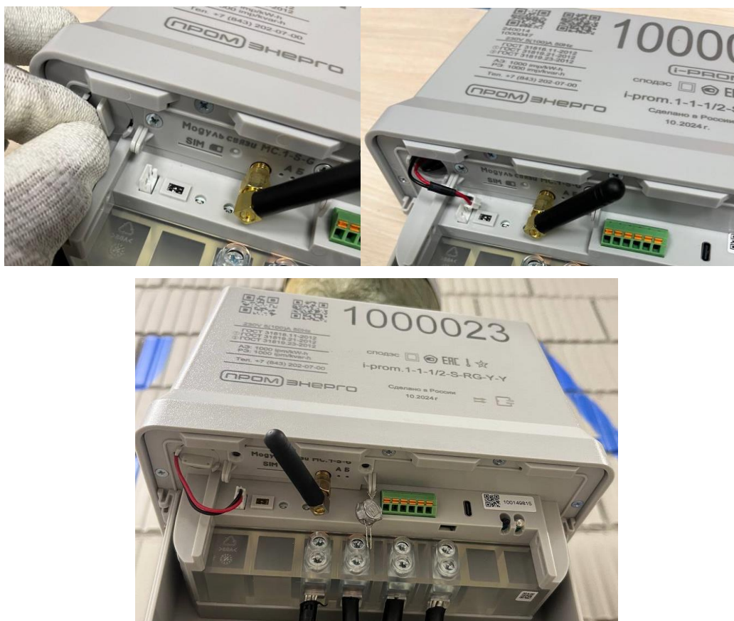
Рисунок 10 – Установка/снятие дополнительного источника питания в счетчик электрической энергии i-prom.1 в корпусе «S»
