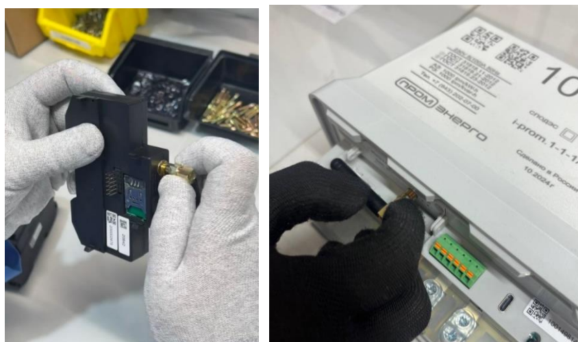
Рисунок 7 – Установка антенны на МС в счетчик электрической энергии i-prom.1 в корпусе «М-МКД» (а), i-prom.1 в корпусе «S» (б)
