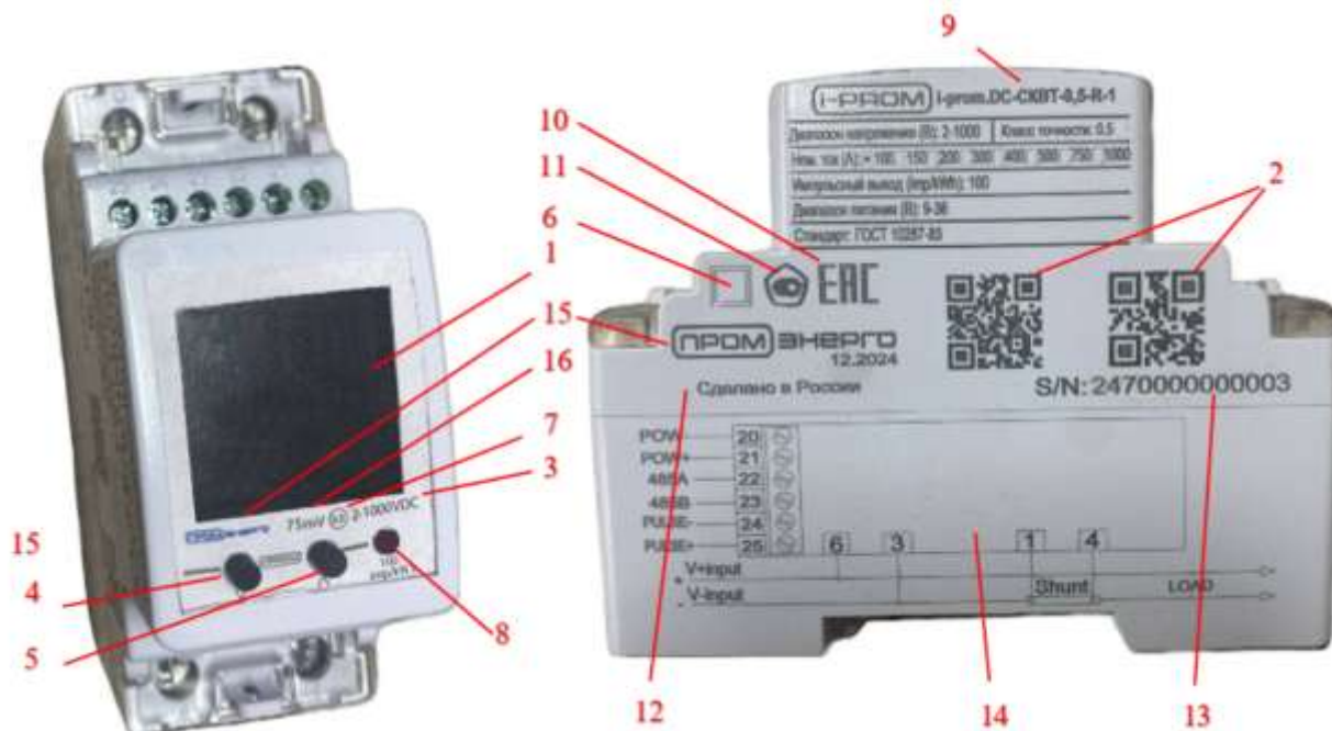
Рисунок 4 – Маркировка счётчика электрической энергии постоянного тока
