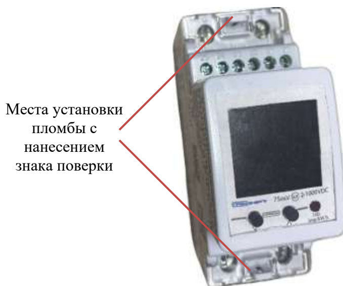
Рисунок 5 – Установка пломб на счетчик электрической энергии постоянного тока
