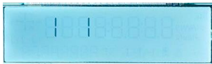
Рисунок 5.2 – Отображение на дисплее версии ПО пульта
