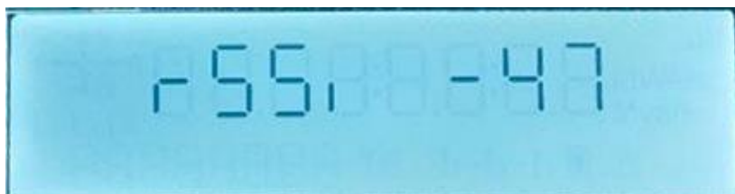
Рисунок 5.7 – Отображение на дисплее уровня сигнала ПУ
