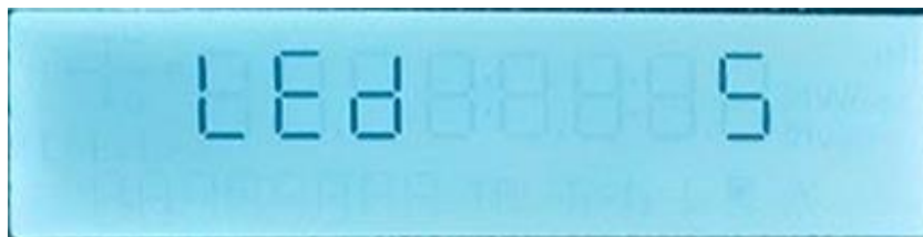
Рисунок 5.6 – Отображение на дисплее уровня подсветки
