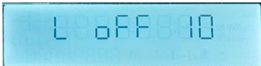
Рисунок 5.8 – Отображение на дисплее значения времени до выключения пульта
