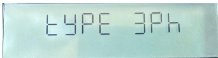
Рисунок 5.3 – Отображение на дисплее пульта типа связанного ПУ
