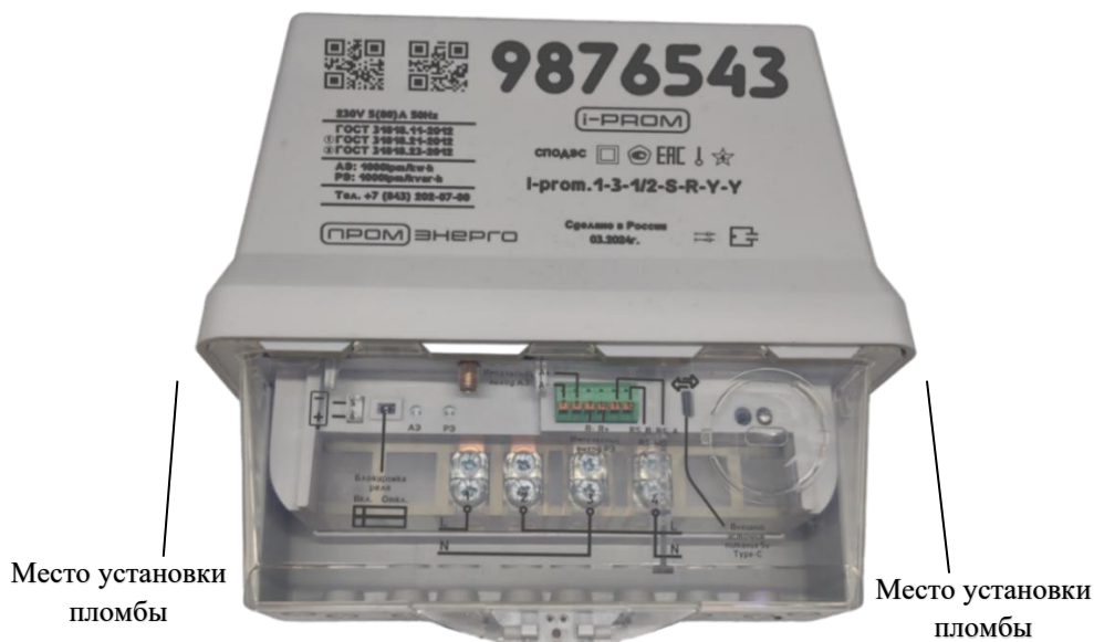
Рисунок 4.6 – Установка пломб на счетчик электрической энергии однофазный многофункциональный i-prom.1 в корпусе S – Split
