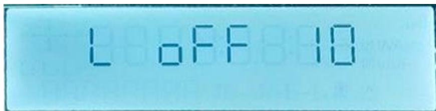
Рисунок 5.9 – Отображение на дисплее значения времени до выключения пульта
