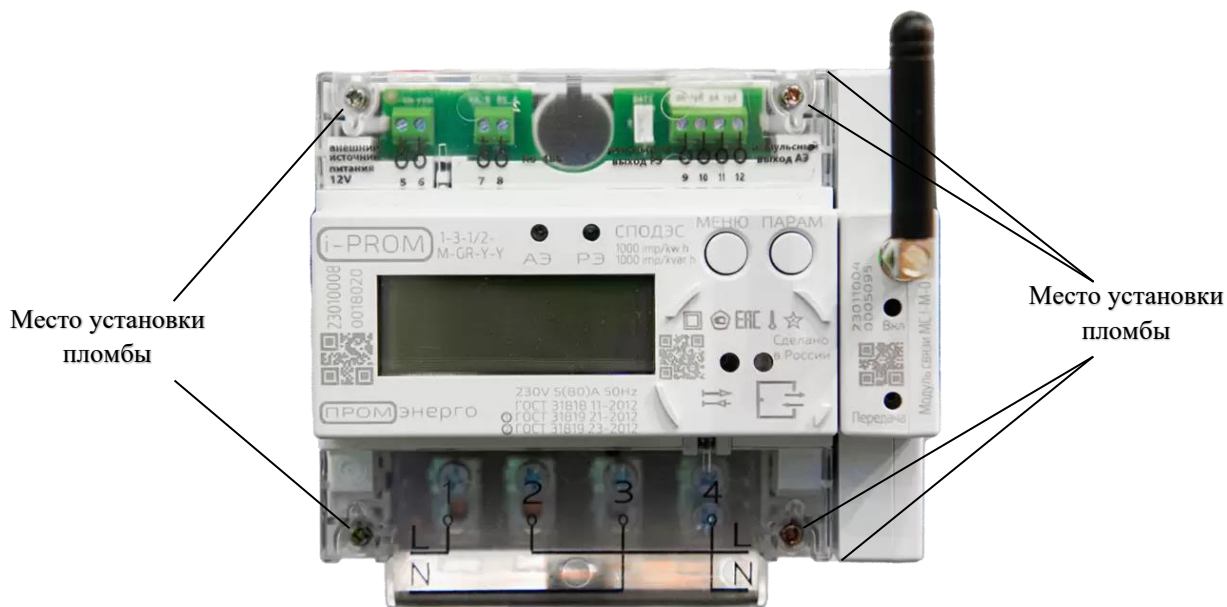
Рисунок 4.5 – Установка пломб на счетчик электрической энергии однофазный многофункциональный i-prom.1 в корпусе М – МКД
